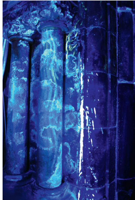
Abb. 11: UV-Aufnahme der östlichen Doppelsäule der Nordarkade mit wellenförmigen Marmorierungen (Foto: Elke Umminger-Gundacker)
